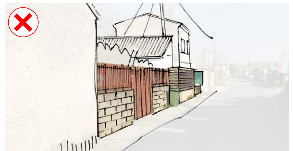
Une juxtaposition de clôtures composées de matériaux hétérogènes, murs en parpaings bruts surélevé d'une grille métallique, palissade en bois
