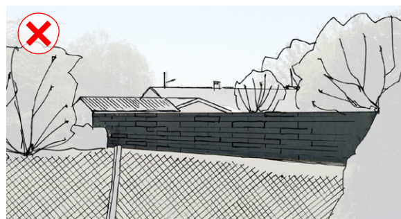
Mur béton brut toute hauteur non enduit, à proscrire en particulier en limite de chemins et d'espaces naturels
